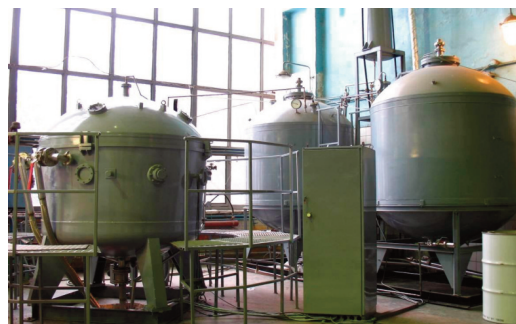
Рис. 2. Общий вид автоматизированной установки для очистки и обезжиривания крупногабаритных ДСЕ ЖРД растворителями хладон 141b, хладон 122
