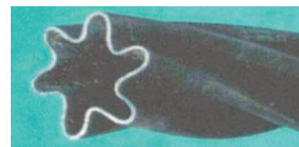
Рис.5. Схема (а) и внешний вид (б) спирально-профильной трубы (СПТ)
